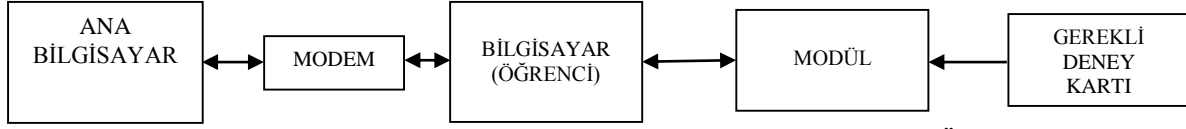
Şekil 2. Bilgisayar Kontrollü Deney Kartlarını Oluşturan Temel Ögeler
